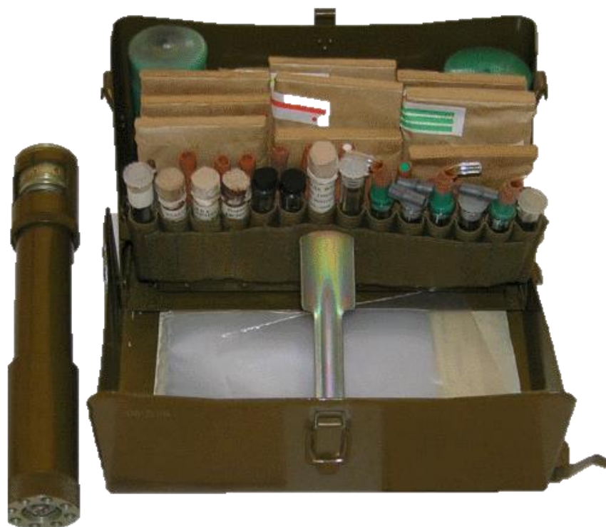
Рисунок 4.24. Прибор химической разведки медицинской и ветеринарной служб ПХР-МВ
